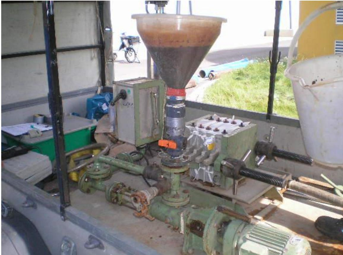
Trennung von fest und flüssig in einer Laborkammerfilterpresse
