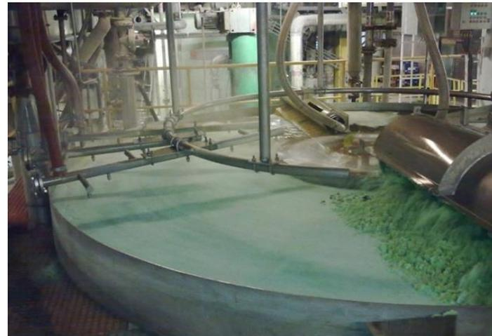
Abtrennung von Eisen(II)-sulfat
