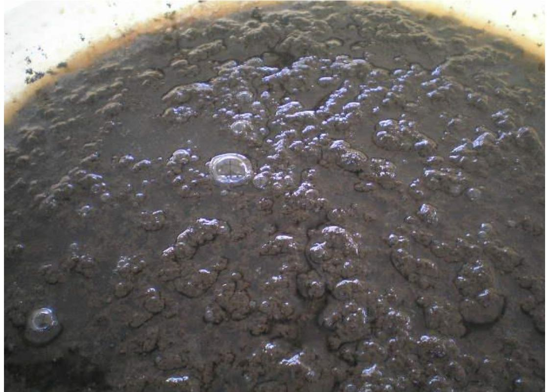
Konditionierung mit 20l FERRIFLOC/m<sup>3</sup> + 15 kg PE/t TR
